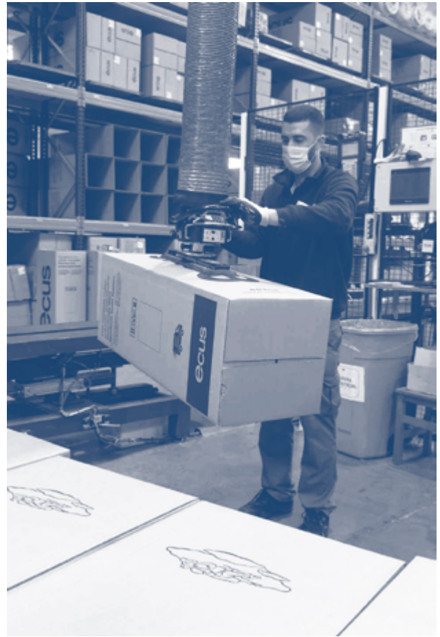
Manipulación de colchones enrollados mediante sistema de vacío en la línea de embalaje.
